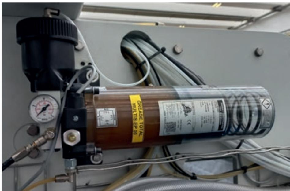
Reduzierter Wartungsaufwand dank serienmäßiger automatischer Zentralschmieranlage
